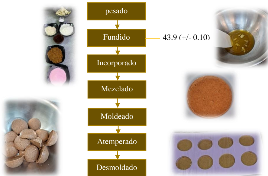
Figura 3. Diagrama de proceso de chocolate funcional aguaje
