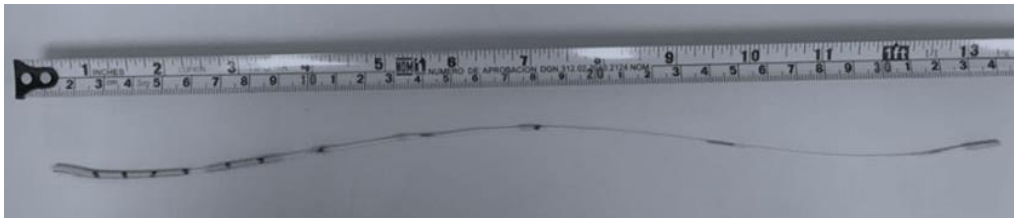
Figura 3.2 Filamento después de ser ensayado a tracción
