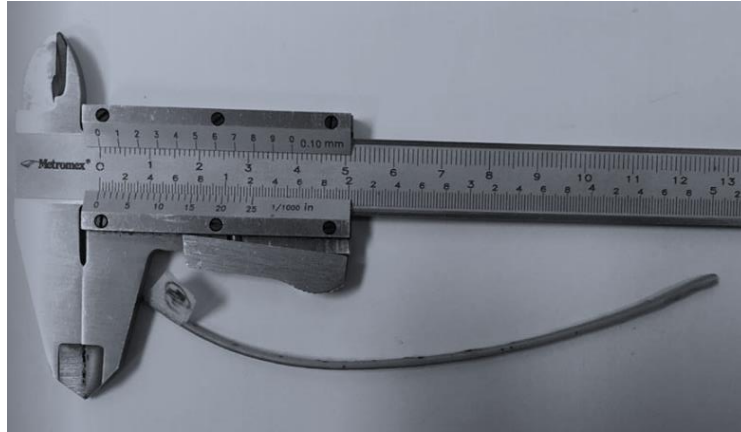
Figura 2.4 Filamento polimérico previo al ensayo de tracción
