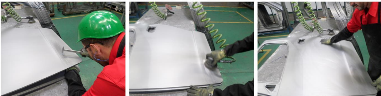
Diagrama 15. Reparación de defecto de bola en panel estampado de la parte RR DOOR OTR RH ("Puerta trasera derecha")
