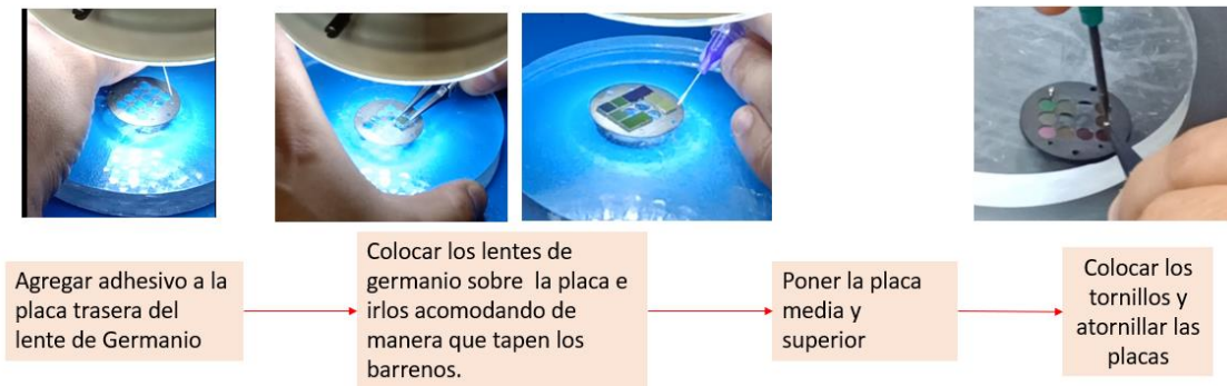
Figura 7. Ensamble del Módulo de Filtros.
