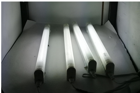
Figura 2.9: Sistema de iluminación por contraste backlight utilizado.
