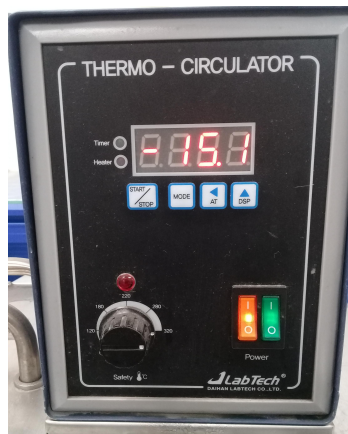
Figura 2.8: Fotografía del regulador de temperatura.
