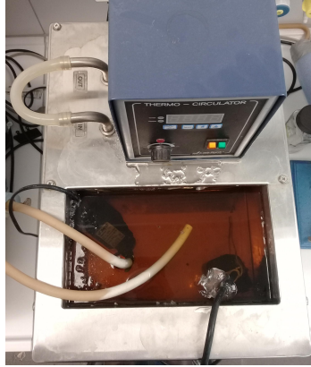
Figura 2.7: Fotografía del contenedor de anticongelante.
