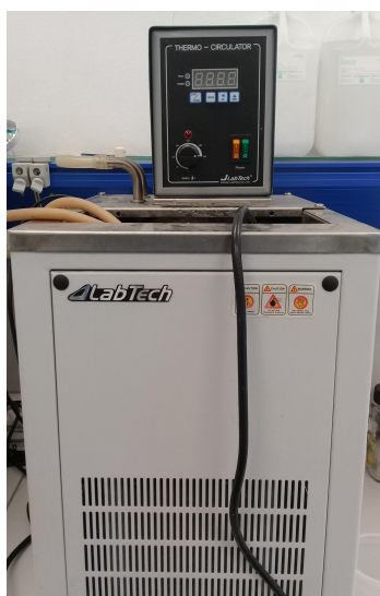
Figura 2.6: Fotografía del sistema de enfriamiento.
