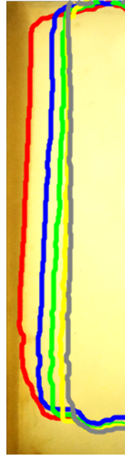
Figura 3.10: Contornos representando el crecimiento del frente de hielo para una concentración del 0.4 %. El orden cronológico de crecimiento del frente de hielo está dado por los colores: rojo (tiempo inicial), azul (5 min), verde (10 min), amarilla (15 min) y gris (21 min).
