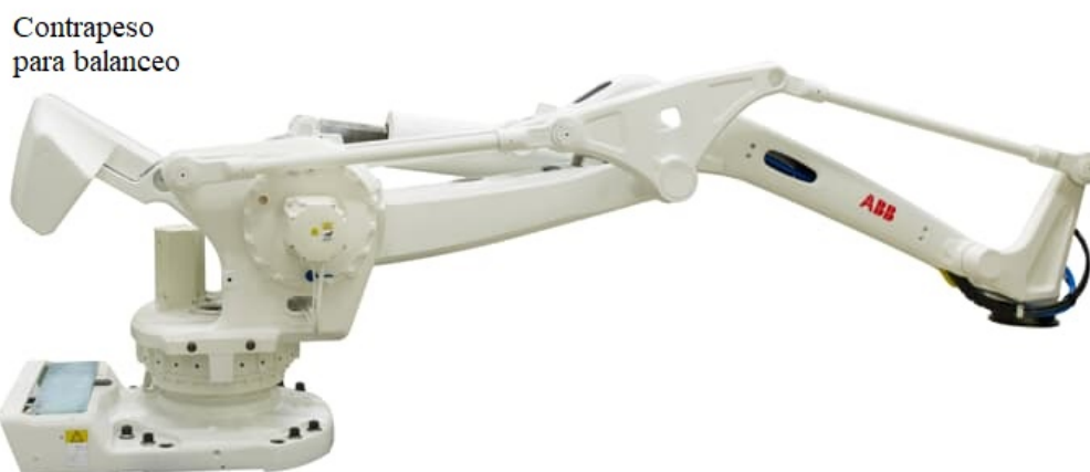
Figura 1-1.: ABB IRB760 en el que se observa con claridad el contrapeso utilizado para llevar a cabo el balanceo estático del mecanismo [1].
