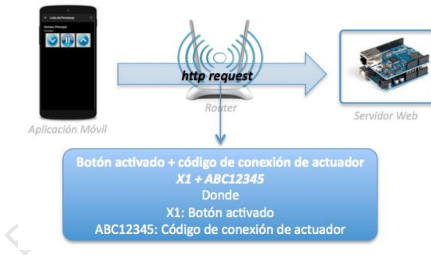
Figura 45. Contenido del http request a enviar a servidor Web de la aplicación.
