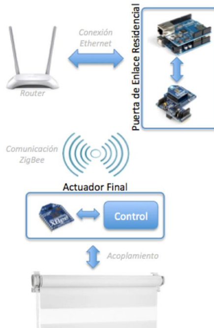
Figura 43. Esquema gráfico de elementos de hardware de prototipo domótico.
