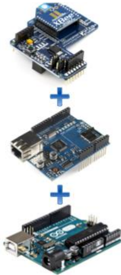
Figura 47. Elementos finales de la Puerta de Enlace Residencial.
