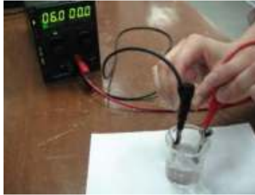
Figura 2.13 Ataque electrolítico de ácido oxálico al 10% de las muestras
