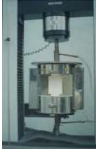
Figura 2.2 Probeta montada en la máquina INSTRON con horno y enfriadores colocados
