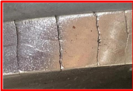
• Figura 12.- Herramental dañado y usillo con fracturas.
