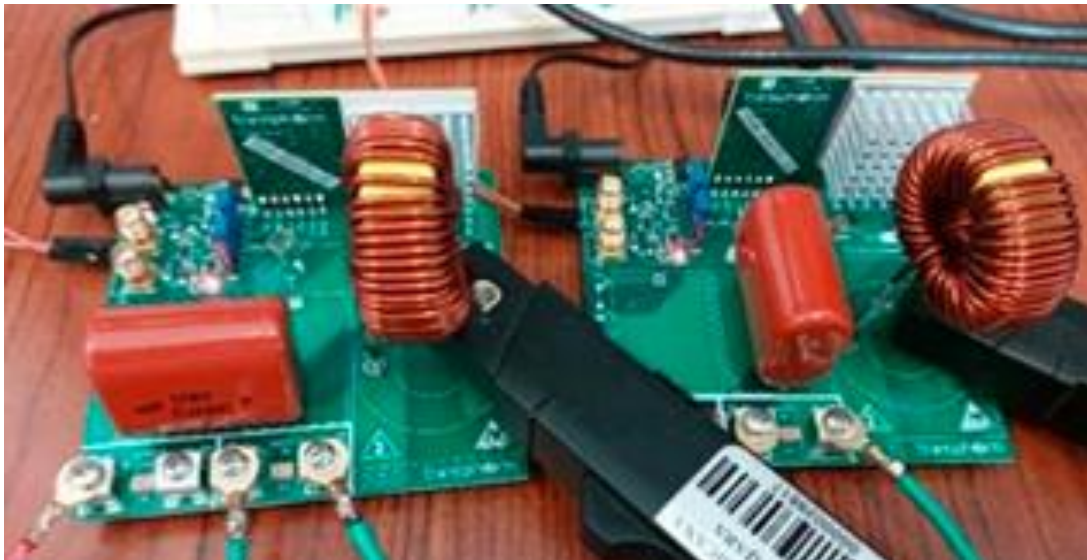
Fig. 8.7. Prototipo experimental con las sondas activas de medición de corriente.
