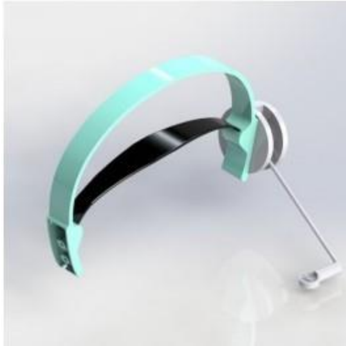
Figura 4.1: Diadema con anemómetro [13]
