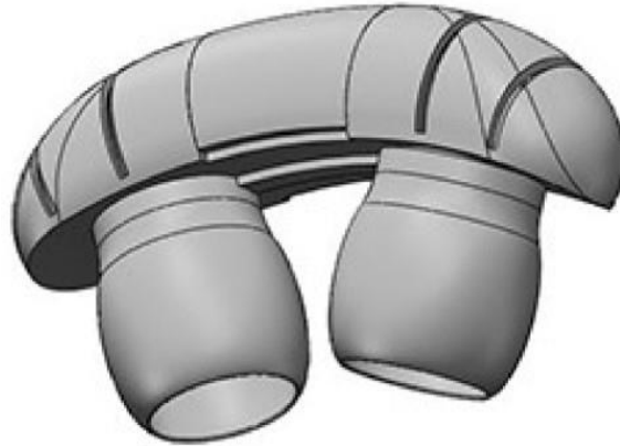
Figura 4.4: Dispositivo de medición de la frecuencia respiratoria propuesto por Qing (CN112043275A) [30]
