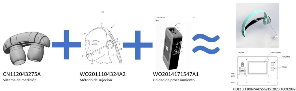
Figura 4.7: Elementos que al combinarse podrían resultar en un dispositivo similar al expuesto en el artículo de Flores et al. [13]. Gráfico de creación propia con Figuras extraídas de los inventos de Qing (CN112043275A) [30] Schwab (WO2011104324A2) [51] y el de Akira et al. (WO2014171547A1) [1]
