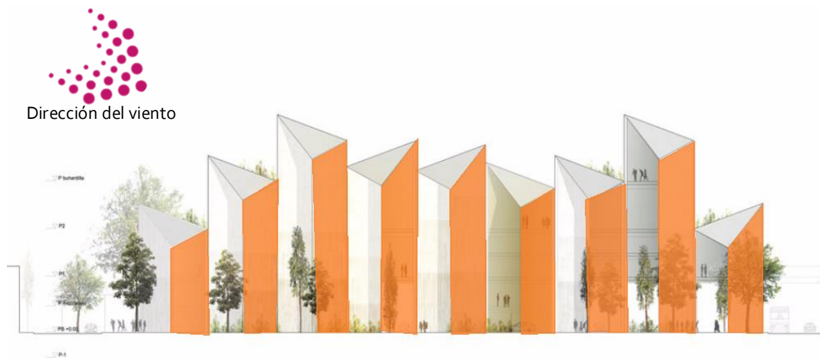
FIGURA 34. FACHADAS NORTE. FACHADAS CLAVE PARA APLICACIÓN DE PINTURA FOTOCATALÍTICA EN ALZADO. SPRB+MX_SI. 2020.
