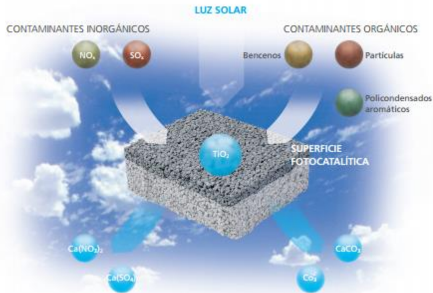
FIGURA 26. PRINCIPIO FOTOCATALÍTICO SOBRE ADOQUÍN PREFABRICADO. BREINCO BLUE FUTURE. 2015
