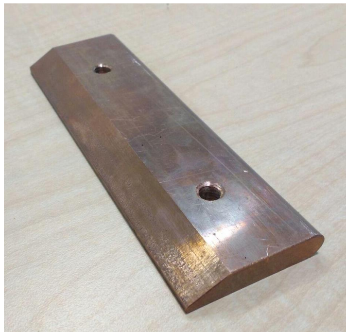
Figura 58. Punta fabricada en cobre Berilio con longitud de 149 mm.
