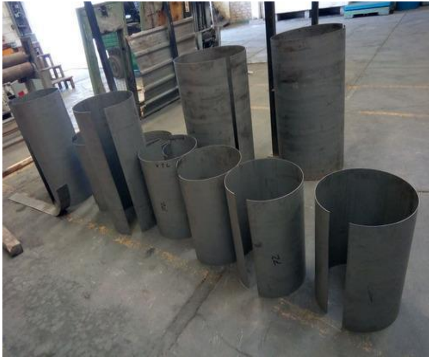
Figura 25. Cilindros rolados en lámina de acero
