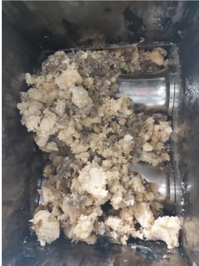
Figura 11. Mezcla del caucho en la máquina Banbury.
