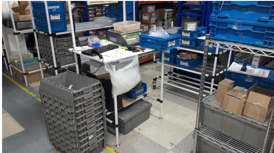
FIG. 33 - Estaciones de creación de kits (estado inicial) sin lugar definido para contenedores vacíos
