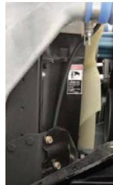
Figura 35: Radiador y tanque de diesel
